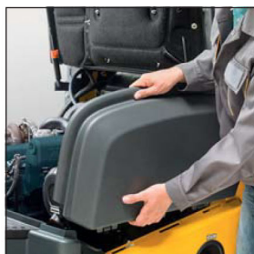
Rimozione parti laterali semplice e senza attrezzi.
