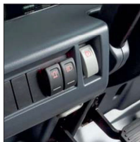
Freno di parcheggio elettrico attivabile tramite pulsante.
