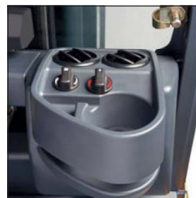
Riscaldamento comprensivo di bocchette d'aria per il parabrezza.
