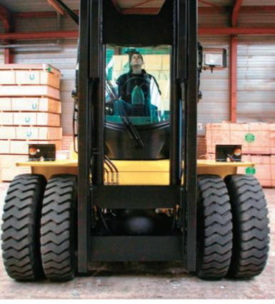
La gamma H8-16XM-6 è disponibile con un motore diesel Cummins. Questo motore è conforme alle direttive sulle emissioni NRMM fase IIIA:
